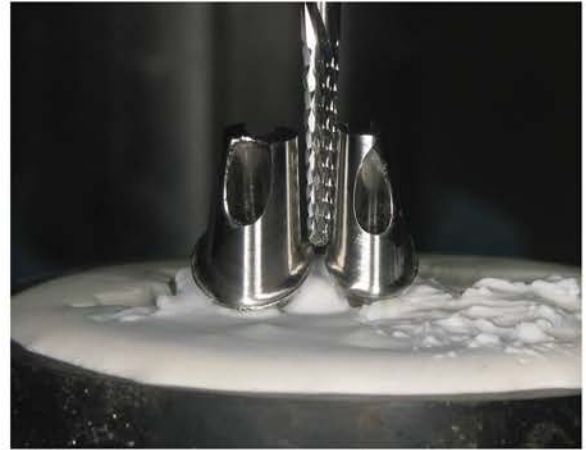
Abb. 12 Fräsen mit 2 Grad
