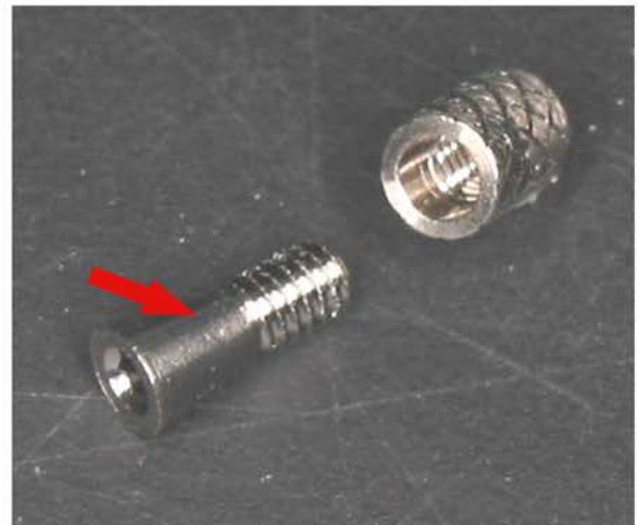
Abb. 14 Schraube mit Hülse. Pfeil zeigt den Übergang vom Primär-zum Sekundärteil.
